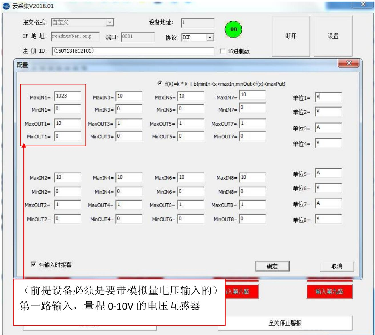
接了一个 0-10V 的电压互感器，点击设置，进行数据校准。
