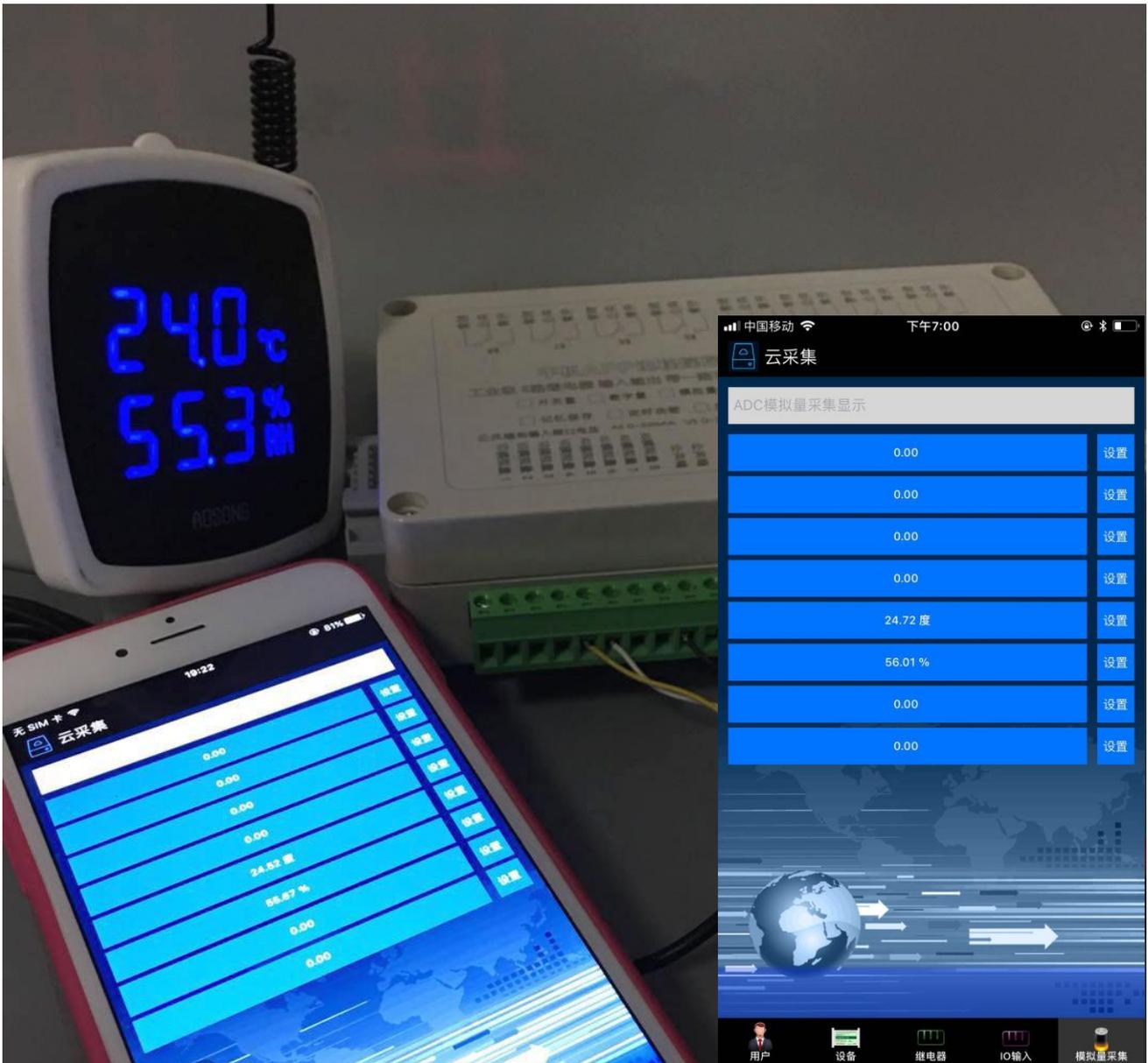
对应的接不同的带模拟量电流或者电压的传感器，可以采集不同的数据，如压力传感器、液位传感器、电流互感器、电压互感器等等都可以远程采集数据。
