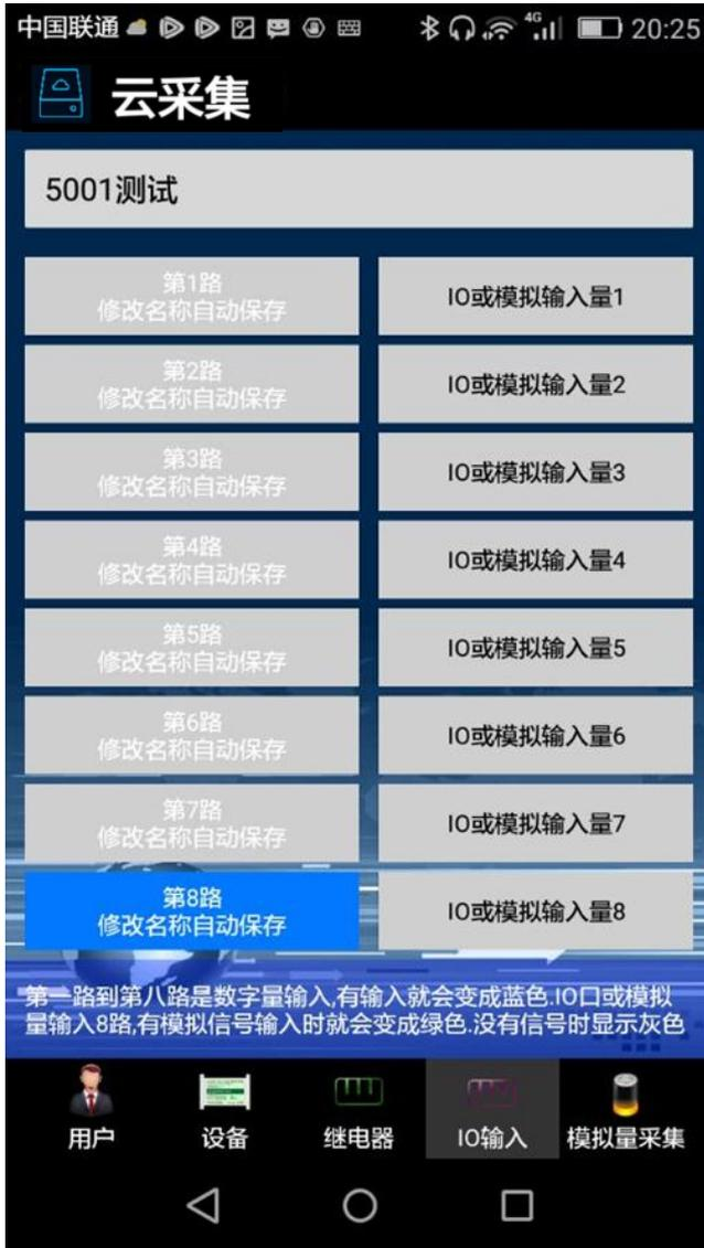
当 IO 口输入检测到有信号输入时，发出一个输出控制指令，让继电器吸合。反之可以打开
