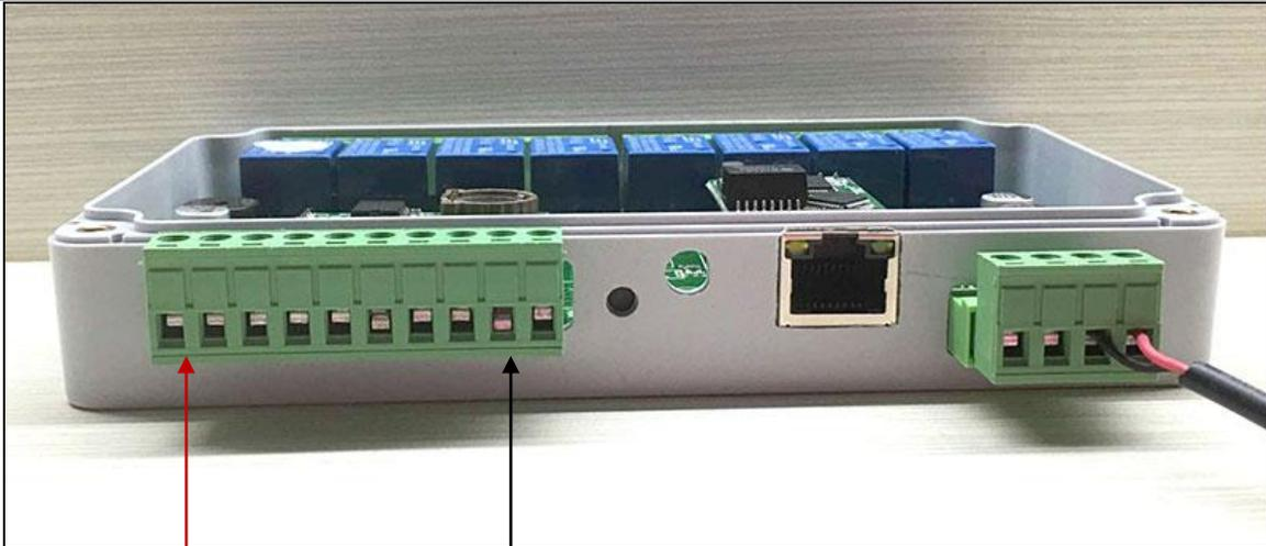
举例：带有电流模拟量 0-20MA 输入端的 PT100 温度传感器接线方法
